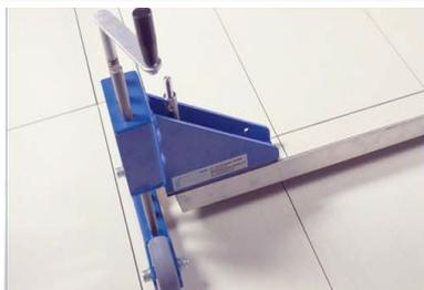
Mit der Spezialkurbel bei beiden EasyLiftern die Abdeckung bis kurz über den Boden anheben.
